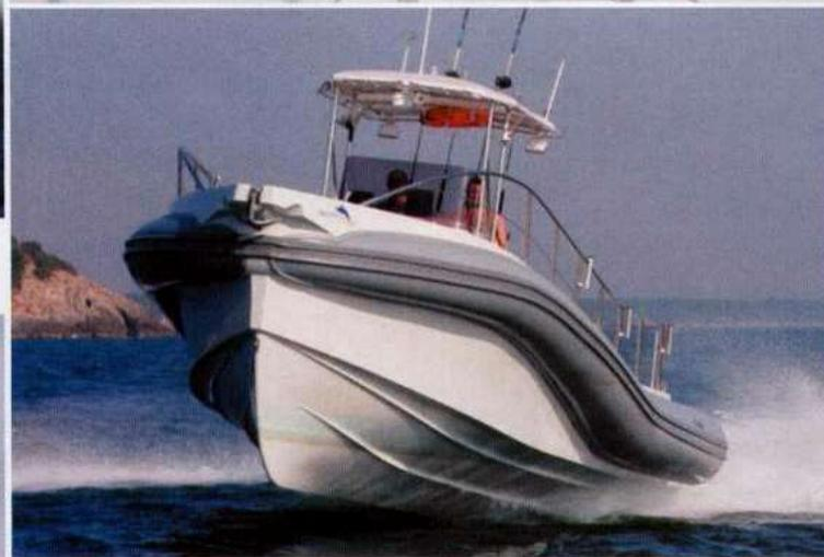
*A sinistra, si può notare l'affilata e profonda ruota di prua, tesa a favorire l'ingresso nell'onda, rendendo così più dolce la navigazione. I test del cantiere evidenziano una velocità massima raggiunta di 43 nodi.*
